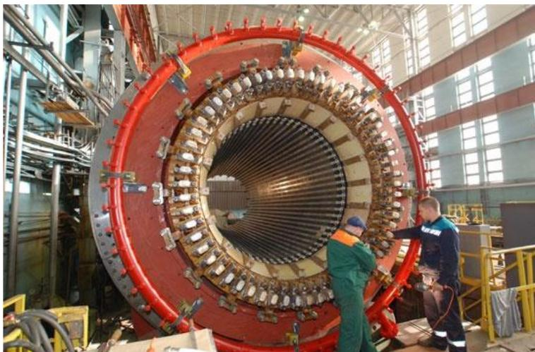
Рис. 1. Статор турбогенератора Нововоронежской АЭС-2 [3]
