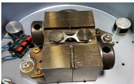
Рис. 1. Установка для проведения термоусталостных испытаний
