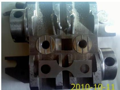
Рис. 1. Установка для проведения экспериментов на термическую усталость
