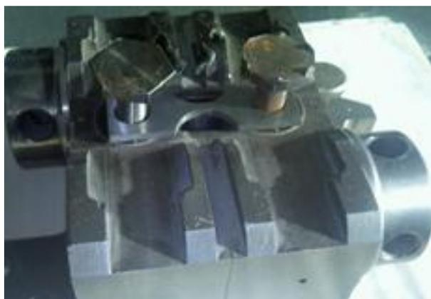
Рис. 1. Установка для проведения экспериментов на термическую усталость
