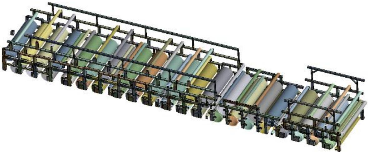
Рис. 2. Конечно-элементная модель секции предварительной сушки
