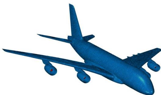
Рис. 1. КЭ модель самолета Airbus A380
