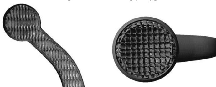
Рис.3. Внутренняя структура имплантата с решетчатыми структурами
