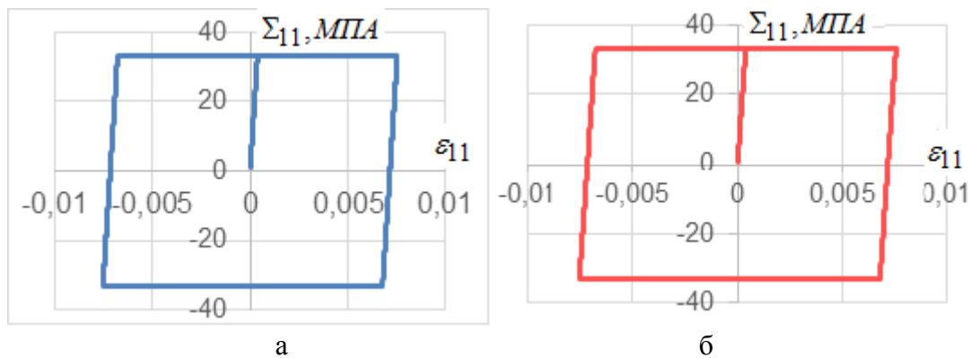
Рис. 1. Кривые упругопластического гистерезиса монокристалла: а) деформирование происходило с этапом упругой разгрузки, б) деформирование происходило без учета упругой разгрузки
