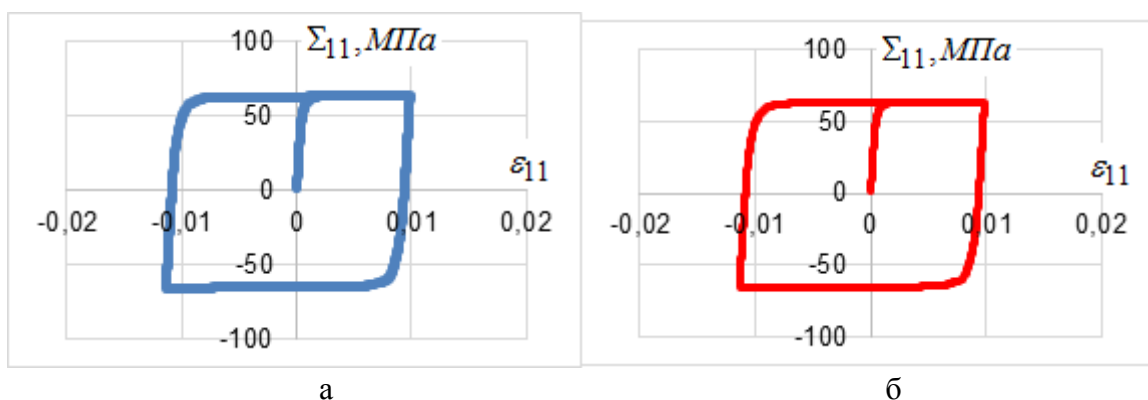
Рис. 2. Кривые упругопластического гистерезиса представительного объема поликристалла: а) деформирование происходило с этапом упругой разгрузки, б) деформирование происходило без учета упругой разгрузки
