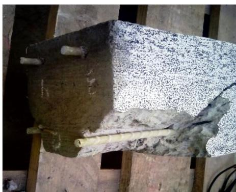
Рис. 5. Характер разрушения бетонной балки армированной СПА
