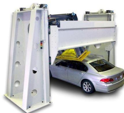
Рис. 2. Проведение теста по исследованию безопасности автомобиля при переворачивании
