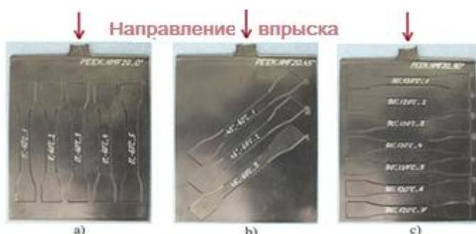
Рис. 1. Образцы для испытаний относительно направления впрыска: а) «0°» б) «45°» в) «90°»
