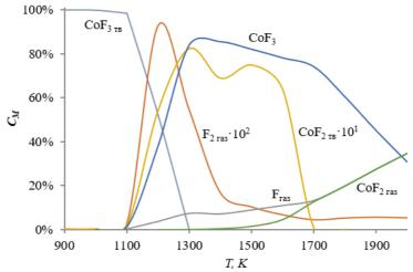
Рис. 1. Зависимость концентраций веществ ( $C_{\rm M}$ , мол. %) в термодинамически равновесной смеси в системе элементов Co-3F в зависимости от температуры, рассчитанная с помощью программного комплекса Астра 4
