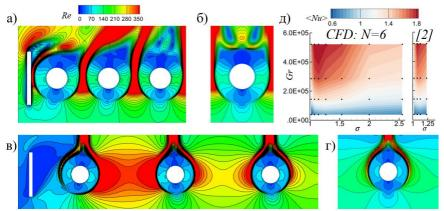
Рис. 3. Поля локального числа Рейнольдса при числе  $Gr = 5.5 \cdot 10^5$  для а, б)  $\sigma = 1.14$  и в, г)  $\sigma = 2.55$  при а, в) N = 6 и б, г)  $N = \infty$ ; д) график зависимости Nu от  $\sigma$
