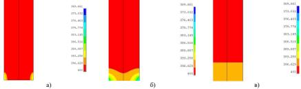
Рис. 2. Распределение давления с течением времени: а) в начальный момент времени; б) в середине: в) в конце
