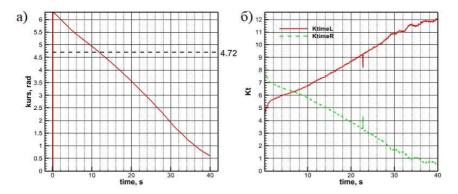
Рис. 2. a) Эволюция курса аппарата при управляемом движении. 4.72 рад – целевое значение курса. 6) Эволюция частоты колебаний левого и правого плавников.
