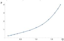
Рис. 1. Нейросетевая аппроксимация производительности клапана подпитки
