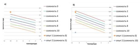
Рис. 1. Расчетные значения предела прочности льда на сжатие (а) и изгиб (б) и соответствующие результаты опытных измерений.
