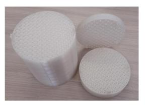
Рис. 2. Внешний вид теплообменной насадки
