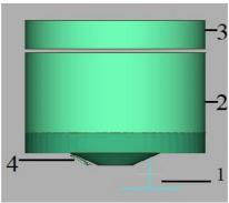
Рис. 2. Модель спектрометра, построенная в программе для расчета прохождения излучения через вещество 1- источник РИ, 2- слой воздуха, 3- исследуемый образец, 4- детектор
