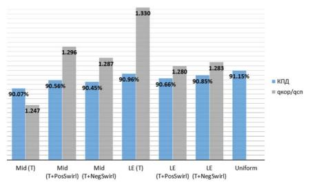
Рис. 4. Влияние положения форсунок и закрутки потока на температурную сепарацию и КПД
