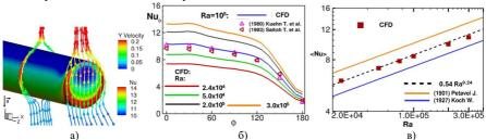
Рис. 2. Расчетные данные для горизонтального цилиндра: а) распределение Nu по поверхности цилиндра и линий тока при Ra =  $3\times10^5$ ; б) распределение Nu $_{\phi}$  по окружному направлению цилиндра; в) значения <Nu>, осредненного по поверхности цилиндра
