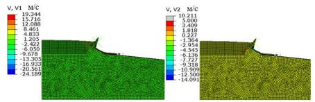
Рис. 1. а) Скорость в горизонтальном направлении потока в момент времени t=5с; 6) Скорость в вертикальном направлении потока в момент времени t=5с
