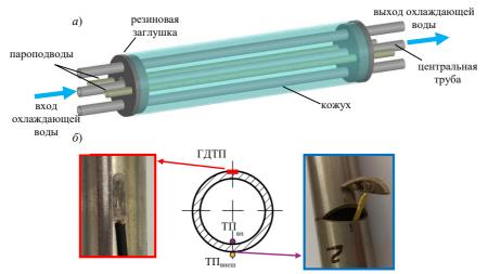
Рис. 1. Экспериментальная установка: a) схема измерительного участка; б) схема расположения первичных преобразователей в сечении трубы
