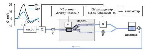
Рис. 1. Схема экспериментальной установки, где Q - датчик электромагнитного расходомера, R - регулятор расхода, V - ультразвуковой датчик, слева - кривые изменения расхода во времени
