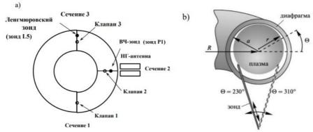
Рис.1. a) Схематическое расположение некоторых экспериментальных устройств – вид на токамак сверху; b) подвижный пятиэлектродный зонд
