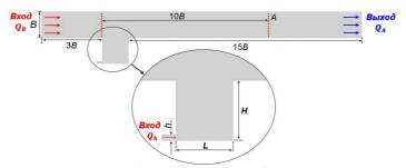
Рис. 1. Геометрия расчетной области
