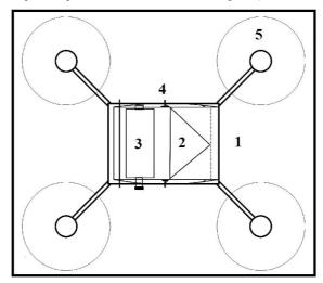
Рис. 1. Схема комплекса на основе DJI Mavic 2; 1 — Фильтрационный модуль расположен на верхней части БПЛА, 2 — Клин-дифлектор, 3 — Катушка с фильтрующей лентой, 4 — Система креплений, 5 — Винты БПЛА
