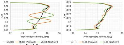
Рис. 2. Угол выхода потока из соплового аппарата
