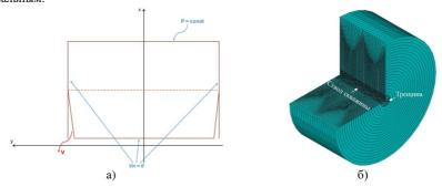
Рис. 1. а) Граничные условия, б) КЭ модель рассматриваемой ячейки периодичности
