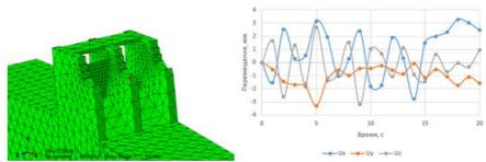
Рис. 2. a) Расположение контрольной точки для измерения перемещения; б) Зависимость перемещений на серединном бычке от времени
