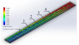
Рис. 2. Поле скоростей: 1 – труба без вставки; 2 – труба с профилированной вставкой; 3 – труба с одной пластиной; 4 – труба с перекрещивающимися пластинами
