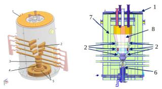
Рис. 1. Схема индукционного плавителя типа «холодный тигель» (ИПХТ) 1 – крышка, 2 – токоподводы, 3 – донный электрод, 4 – охлаждение фильеры, 5 – охлаждение основания, 6 – слив, 7 – теплоизоляция, 8 – область тигля с расплавом
