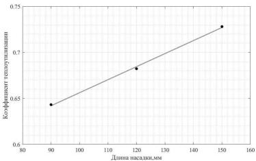
Рис. 3. Зависимость коэффициента теплоутилизации от длины теплообменной насадки
