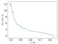
Рис. 4. Расчетная зависимость ротора скорости в центре вихря от его продольной скорости
