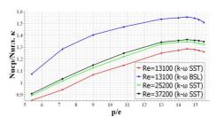
Рис. 4. Зависимость  $Nu_{cp}/Nu_{r\pi.\kappa}$  от шага оребрения
