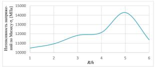
Рис. 6. Зависимость максимального значения интенсивности напряжений по Мизесу от отношения радиуса перовскитной фазы к толщине пленки
