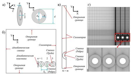
Рис. 1. а) Геометрия оребренной трубы, расчетная область при б) N=6 и в)  $N=\infty$ , г) расчетная сетка
