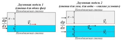
Рис. 3. Двузонные модели с выделением межфазной границы
