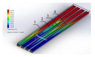
Рис. 3. Поле температур: 1 – труба без вставки; 2 – труба с профилированной вставкой; 3 – труба с одной пластиной; 4 – труба с перекрещивающимися пластинами
