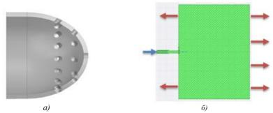
Рис. 1. a) геометрическая модель; б) расчетная область для моделирования аэродинамики распыления жидкости
