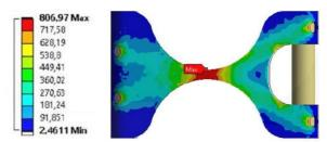
Рис. 3. Интенсивность напряжений по Мизесу в предохранительной пластине, сталь марки 30XГТ, толщина 1 мм
