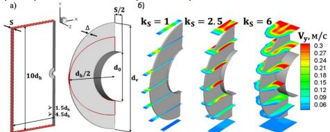
Рис. 1. а) Геометрия расчетной области и пример изменения формы ребра (красная сплошная линия), б) распределение скорости  $V_v$  для разных значений  $k_S$
