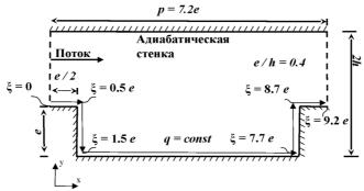
Рис. 1. Геометрия канала
