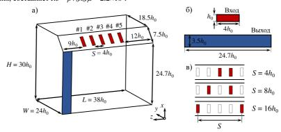
Рис. 1. а) расчетная область, б) размеры входов и выхода, в) входные сечения для вариантов #2 - #4
