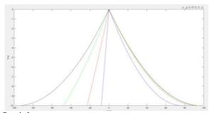
Рис. 4. Формы тросов при различных натяжениях и длинах. Длины проекций левого троса: черный: 94 м, зеленый 49 м, красный 24 м, синий: 9 м
