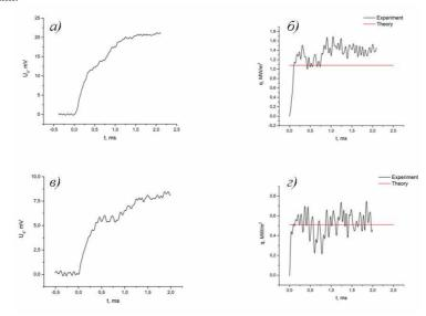
Рис. 2. Электрические сигналы датчика и рассчитанный по нему тепловой поток, полученные в режиме 1 (а и б) и режиме 2 (в и г)
