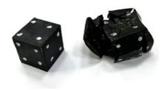
Рис. 2. Образцы из компаунда СТЭП-К197 до и после испытаний на сжатие
