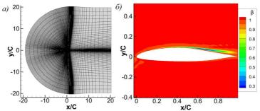
Рис. 1. Пример расчетной области и сетки (а) и поле β, полученное в результате оптимизации (б) для профиля s805.
