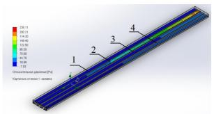
Рис. 5. Поле относительных давлений: 1 – труба без вставки; 2 – труба с профилированной вставкой; 3 – труба с одной пластиной; 4 – труба с перекрещивающимися пластинами
