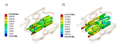
Рис. 4. Радиальные перемещения стента с синусоидальной формой ячеек: а — в сжатом состоянии; б — в состоянии после релаксации
