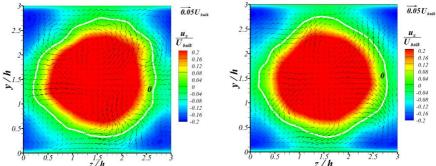
Рис. 5. Поле осредненной продольной скорости и векторное поле осредненного поперечного течения в поперечных сечениях: x=7h для Fluent (слева) и x=7.5h для SINF/Flag-S (справа)
