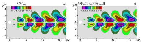
Рис. 2. Пространственные распределения возмущений продольной скорости, полученные на сетке L4 прямым численным решением нестационарных уравнений Навье — Стокса (а) и с помощью лискретного ГАУ (б).
