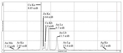
Рис. 1. Спектр флуоресценции образца
