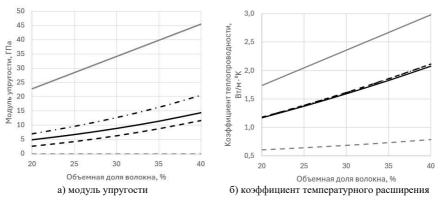
Рис. 3. Зависимость эффективных характеристик от объемной доли волокна, титановый сплав Ti-6Al-4V – кровяной сгусток
