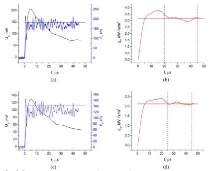
Рис. 2. Сигнал датчика теплового потока (черная кривая), измеренное давление за отраженной ударной волной (синяя кривая) и приведенный тепловой поток (красная кривая), полученный в режиме M=2.45 (а и b) и режиме M=2.24 (с и d).
