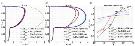
Рис. 2. Результаты расчетов на разных сетках: а) профили скорости при использовании стандартного VOF; б) профили скорости при использовании VOF с поправкой Егорова; в) среднерасходная скорость газа при использовании VOF с поправкой Егорова
