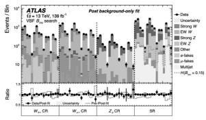
Рис. 2. Распределение величины инвариантной массы двух струй для контрольных и сигнальных областей после процедуры фитирования с использованием метода максимального правдоподобия
