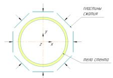
Рис. 3. Постановка задачи предварительного сжатия
