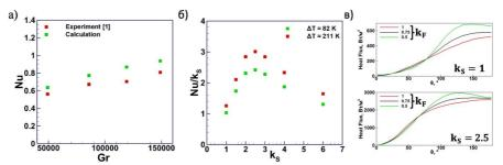
Рис. 2. а) Теплоотдача при разных значениях Gr, полученная в расчетах и в эксперименте [1], б) значение Nu на единицу длины для разных  $k_5$ , в) изменение теплового потока вдоль  $\theta$
