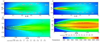
Рис. 1. а) наложение поля функции тока на поле температуры для реакции (2); б) наложение поля массовой доли ОГФУ на поле температуры для реакции (2); в) наложение поля функции тока на поле температуры для реакции (3); г) наложение поля массовой доли ОГФУ на поле температуры для реакции (3)
