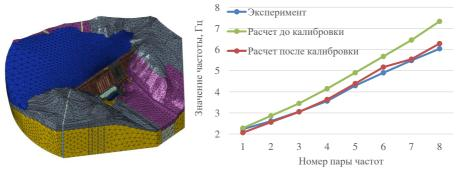
Рис. 1. Трехмерная КЭ модель
