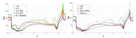
Рис. 3. Распределение числа Нуссельта на нижней стенке и ребрах для  $Re = 1.31 \cdot 10^4$
