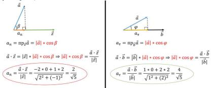
Рис. 4. Расчет нормального и тангенциального ускорения методами математики
