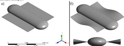
Рис. 1. а) базовая геометрия аппарата, б) аппарат с деформированным плавником.
