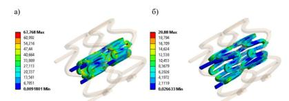
Рис. 5. Интенсивность напряжений по Мизесу стента с синусоидальной формой ячеек: а — в сжатом состоянии; б — в состоянии после релаксации
