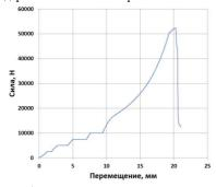
Рис. 3. Зависимость силы от перемещения для образца №1
