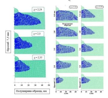
Рис. 1. Распространение трещины в модели образца NDT (показана 1/2 излома), материал — сталь  $F460^{Arc30}$
