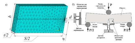
Рис. 1. а) Геометрия и КЭ - сетка численной модели ¼ образца на 3-х точечный изгиб для большого и малого образцов: б) Схематическое изображение испытания на трехточечный изгиб: в) Эскиз образца испытания на трехточечный изгиб. Размеры большого образца: S = 305, t = 38, b = 76, a = 38, d = 2.5[мм]; малого образца: S = 119, t = 14, b = 38, a = 14, d = 2.5[мм]
