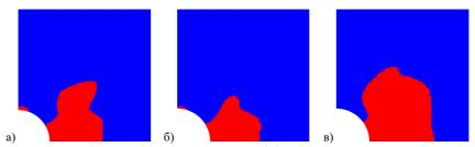
Рис. 3. Зоны пластичности при нагрузке 250 МПа для ориенации пластины: а) [001]; б) [011]; в) [111]
