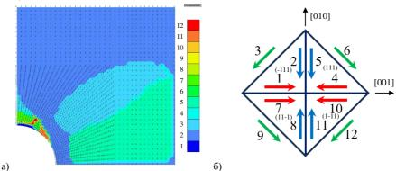
Рис. 2. a) Зоны доминирования различных СС для пластины с отверстием КГО [001], б) направления скольжения для 12 СС
