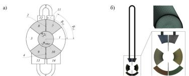
Рис. 1. Схема роторно-лопастного двигателя с внешним подводом тепла (a), расчетная область и сетка (б)
