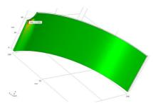
Рис. 2. Распределение рассчитанного количества выдерживаемых циклов
