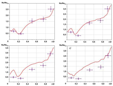
Рис. 3. Относительное число в переходном сечении Нуссельта ОТЛ для различных углов наклона  $\theta$ : a) 30°; б) 45°; в) 60°; г) 75°
