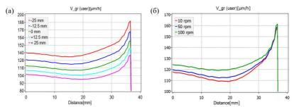
Рис. 7. Влияние расположения индукторов (a) и скорости вращения затравки (б) на скорость роста
