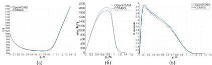
Рис. 3. Сопоставление распределений вдоль x=0 (a) – температуры, (б) – вязкости, (в) – модуля скорости для двух программных пакетов
