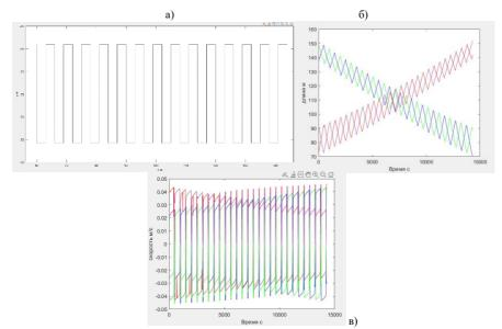
Рис. 5. a) Форма движения баржи, б) изменение длин тросов со временем, в) изменение скоростей выборов тросов (различными цветами обозначены скорости соответствующих тросов)
