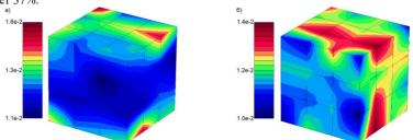
Рис. 5. Распределения полей осевых пластических деформаций: а) модель Каето (1), б) обобщенная модель (2)
