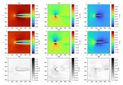
Рис. 1. Картины полей при угле атаки, равном -0.21°: 1 – поля продольной скорости, 2 – поля поперечной скорости, 3 – поля давления; а) – рассчитанные поля, б) – предсказанные поля, в) – поля абсолютной ошибки.
