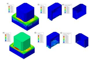
Рис. 2. Песок рыхлый: а) суммарные перемещения, б) поврежденность бетона, в) пластические деформации в арматуре Рис. 3. Песок плотный: а) суммарные перемещения, б) поврежденность бетона, в) пластические деформации в арматуре
