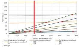
Рис. 3. Диаграмма Кэмпбелла для рабочей лопатки, изготовленной литьем из сплава IN738LC
