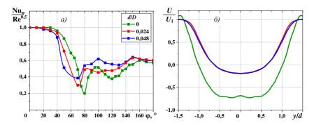
Рис. 2. Распределение числа Нуссельта по полуповерхности цилиндра (а) и профиль продольной составляющей скорости в следе за цилиндром на расстоянии x/d=1,5 (б) с/без стержней-турбулизаторов (Re = 9600).
