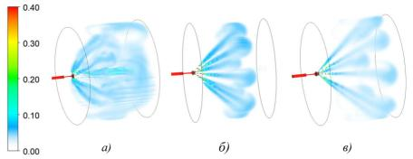
Рис. 2. Объемная доля газа в камере сгорания, в которой установлены: а) завихритель; б) сопло; в) комбинированная форсунка (завихритель и сопло)
