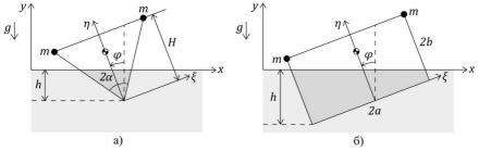
Рис. 1. Плавающее тело с грузами в жидкости: а) треугольный брус, б) прямоугольный брус
