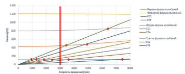
Рис. 5. Диаграмма Кэмпбелла для монокристаллической рабочей лопатки из сплава IN738LC
