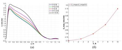
Рис. 5. (a) – Распределение вертикальной компоненты скорости вдоль x=0, (б) – Зависимость максимальной скорости от разности потенциалов на электродах
