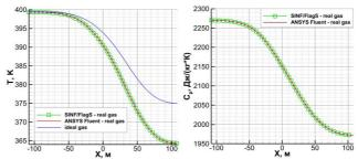
Рис. 1. Расчетные кривые, полученные по коду SINF/Flag-S и коду ANSYS Fluent: распределения температуры (слева), распределения теплоемкости (справа)
