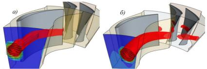
Рис. 1. Положения форсунок относительно соплового аппарата
