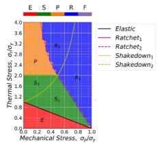
Рис. 1. Диаграмма типа Бри, полученная с помощью разработанной процедуры в ПС Matlab
