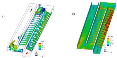
Рис. 3. Картина течения и теплообмена в канале с ребрами: а) изоповерхность Q-критерия и б) распределение числа Нуссельта по стенкам канала
