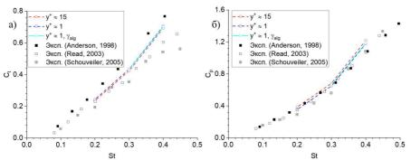
Рис. 3. Зависимость силовых характеристик профиля от числа Струхаля: а) коэффициент тяги, б) коэффициент энергетических затрат
