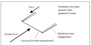
Рис. 1. Общая схема ТА датчика
