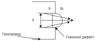
Рис. 2. Схема истечения, F- площадь сквозного отверстия, р – рабочее давление газа, ро – давление внешней среды
