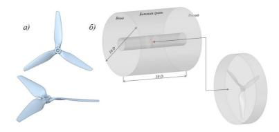
Рис. 1. а) геометрия воздушного винта НОРгор 9х5х3; б) геометрия расчетной области
