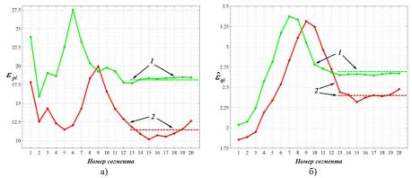
Рис. 4. Распределения вдоль канала а) параметра увеличения гидравлического сопротивления  $\epsilon_{pi}$ , и б) параметра интенсификации теплоотдачи  $\hat{\epsilon}_{qi}$  на оребренной стенке: линии 1 – канал с W/H=1.5, линии 2 – канал с W/H=1.0, сплошные линии –зависимости на начальном участке, пунктирные линии –значения  $\epsilon_p$  и  $\hat{\epsilon}_q$  в развитом течении  $(1-\epsilon_p=18.14,\,\hat{\epsilon}_q=2.69;\,2-\epsilon_p=11.46,\,\hat{\epsilon}_q=2.40)$
