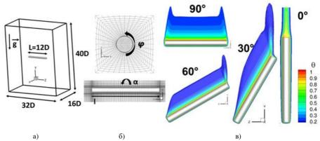
Рис. 1. а) Геометрия расчетной области; б) фрагмент расчетной сетки в двух сечениях; в) поля безразмерной температуры, полученные при разных значениях  $\alpha$  для  $Ra = 3 \times 10^5$
