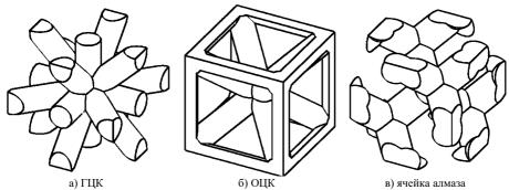
Рис. 1. Рассматриваемые типы ячеек периодичности при объемной доле волокна 30%
