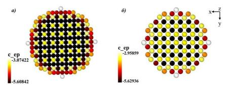
Рис. 1. Распределение потенциальной энергии на поперечных срезах моделей кристаллов с радиусом, равным 4a: a) цилиндр; б) сфера
