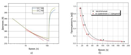
Рис. 3. Кривые падения и восстановления давления для проницаемости 0.5 мД в случае периодической системы трещин (синяя кривая) и одиночной трещины (красная кривая) - а), зависимость время начала интерференции от проницаемости пласта вычисленная на основе фиксации расхождения КПД (красные точки), смены наклона КПД (синие точки) — б).
