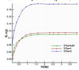
Рис. 4. Зависимость массового расхода от величины противодавления для разных температур стенки
