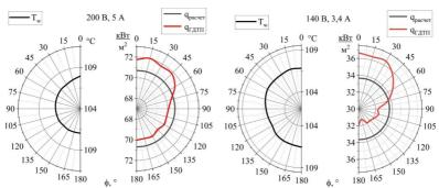
Рис. 3. Зависимость температуры поверхности (слева) и местной ПТП (справа) от угла поворота нагревателя
