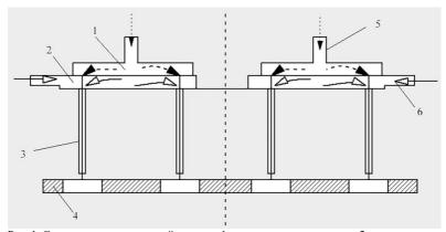
Рис. 1. Схема мультикапиллярной системы 1 – модуль ввода жидкости, 2 – модуль ввода газа, 3 – распылительный эмиттер, 4 – транспортный электрод, 5 – фитинг для ввода жидкости,
