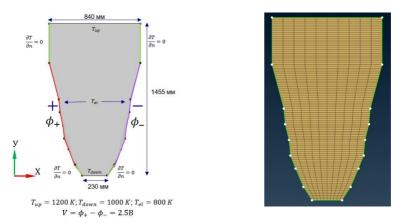
Рис. 2. Расчетная область (слева) и сетка (справа)
