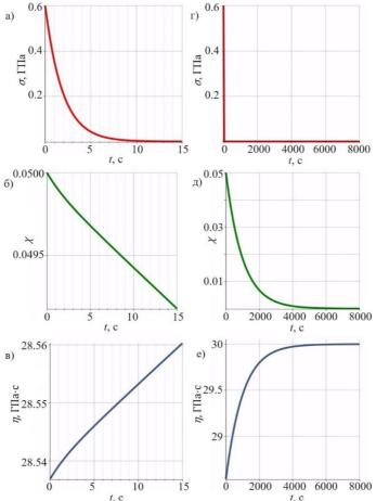
Рис. 2. Релаксация напряжения и зависимость параметра χ и вязкости от времени
