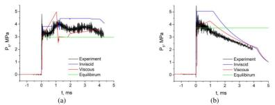
Рис. 2. Измеренное давление за отраженной волной (черные кривые), расчет без учета (синие кривые) и с учетом вязких эффектов (красные кривые) для режима (а) и режима (b). Зеленой линией показано равновесное давление
