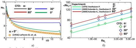
Рис. 3. a) Значения Nu, осредненные по окружному направлению, вдоль оси цилиндра; б) значения Nu, осредненные по площади цилиндра
