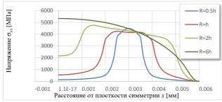
Рис. 5. Распределение полей горизонтальных напряжений (вдоль оси x на уровне y = h/2) для различных стадий роста перовскита от R/h = 1/2 до R/h = 6
