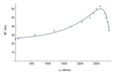
Рис. 1. Нейросетевая аппроксимация механической характеристики электродвигателя
