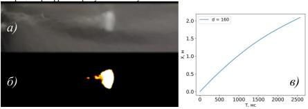
Рис. 1. a) Исходное видео с камеры; б) Обработанное видео, по которому определялось положение вихря; в) Зависимость положения вихря от времени при диаметре сопла генератора d = 160 мм
