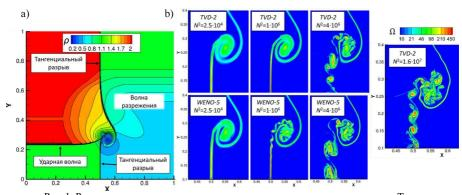
Рис. 1. Результаты для задачи о распаде двумерного разрыва в момент времени  $T_{\text{max}}$ : а) поле плотности (расчет по схеме TVD-2,  $N=2.5\cdot10^5$ ); b) поле завихренности в центре области для всех рассчитанных вариантов
