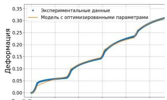
Рис. 8. Сравнение экспериментальных данных с прогнозом реологической модели линейного вязко-упругого материала
