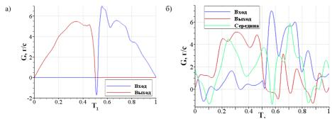
Рис. 3. Зависимость расхода газа на границе между коллекторами и рабочей камерой (a) и расход газа в характерных сечениях трубы (б) за период
