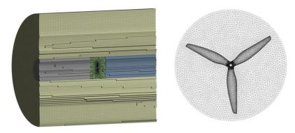
Рис. 2. Расчетная конечно-объемная модель с доменом скользящей сетки
