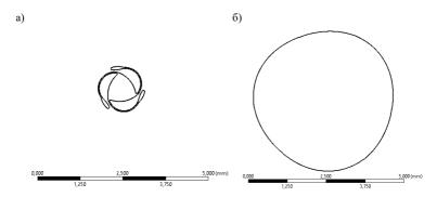
Рис. 6. Результаты моделирования процесса раскрытия баллона: а — 0 с; б — 40 с.
