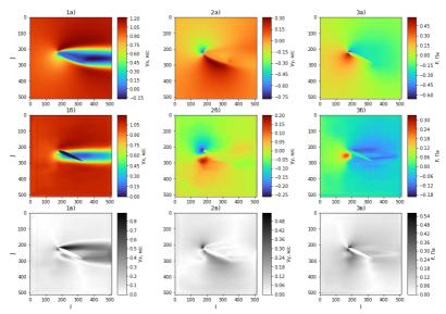
Рис. 2. Картины полей при угле атаки, равном 23.54°: 1 – поля продольной скорости, 2 – поля поперечной скорости, 3 – поля давления; а) – рассчитанные поля, б) – предсказанные поля, в) – поля абсолютной ошибки.
