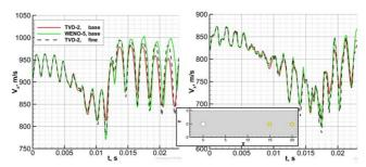
Рис. 3. Временная зависимость продольной составляющей скорости в двух точках мониторинга
