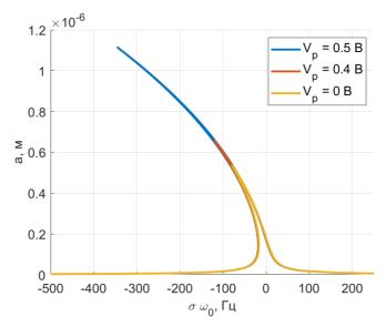
Рис. 2. Резонансная характеристика при  $V_{DC}=2$  В,  $V_f=0.01$  В,  $\varphi=0$
