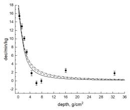
Рис. 3. Нижняя кривая – средний поток СКЛ с  $\gamma$ =6 и вклад от 4-х событий; короткий пунктир – учет всех 8 событий таблицы; штрихпунктирная – с дополнительным вкладом подобных событий за период 10000–20000 лет назад. Экспериментальные точки - керн 15001-6 после вычитания В1.
