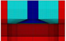
Рис. 3. Расчетная сетка во Flow Module, 23 тыс. ячеек
