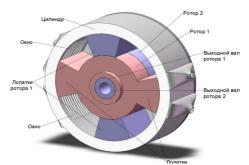
Рис. 1. Устройство РЛМ
