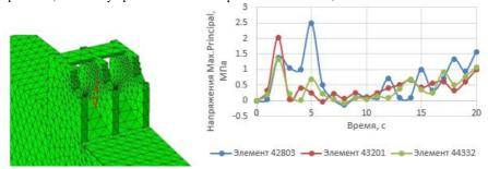
Рис. 3. a) Расположение контрольных элементов для измерения напряжений; б) Зависимость напряжений на серединном бычке от времени
