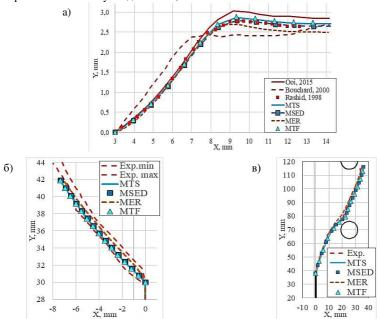
Рис. 2. Расчетные траектории: а) задача о растяжении пластины с круговым отверстием, б) задача о трехточечном изгибе балки с тремя круговыми отверстиями
