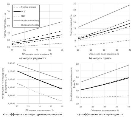
Рис. 2. Зависимость эффективных характеристик от объемной доли волокна, титановый сплав Ti-6Al-4V – кортикальная кость
