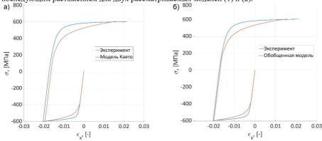
Рис. 4. Сравнение прогнозов а) модели Касто (1), б) обобщенной модели (2) с экспериментальными данными
