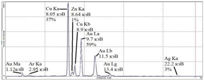
Рис. 3. Восстановленный и измеренный на макете рентгенофлуоресцентного анализатора спектры
