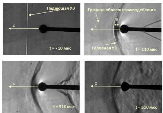
Рис. 1. Теневые картины обтекания цилиндра в различные моменты времени после контакта падающей ударной волны с цилиндром
