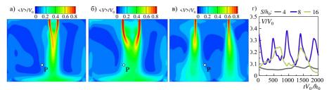
Рис. 3. Распределения осредненной скорости в сечении A для вариантов: а) #2, б) #3, в) #4, г) эволюция скорости в точки мониторинга P по данным URANS расчетов
