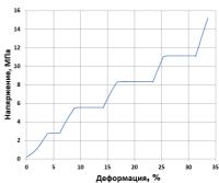
Рис. 4. Зависимость напряжения от деформации для образца №1
