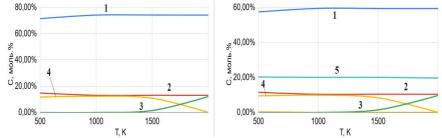
Рис. 1. Концентрация компонентов С (моль. %) в термодинамически равновесной смеси веществ в системе элементов *a) Li-P-6F-2O-4H* и *б) Li-P-6F-8O-8H-2C* в зависимости от температуры  $T: 1 - HF_{zaj}; 2 - H_2O_{zaj}; 3 - LiPO_{3 колд}; 4 - LiPO_{3 zaj}; 5 - CO_{2 zaj}$
