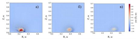
Рис. 2. Моделирование распространения вихря через время t после его генерации: а) t = 100 мс; б) t = 180 мс; в) t = 260 мс
