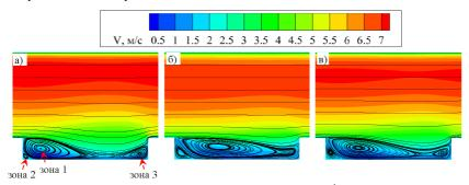
Рис. 2. Поля скорости с линиями тока для  $Re = 1.31 \cdot 10^4$ , полученные по трем моделям турбулентности: a) k- $\epsilon$ , б) k- $\omega$  SST, в) Спаларта-Аллмараса
