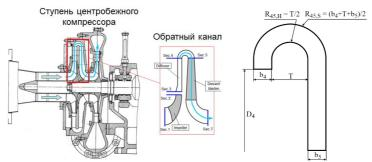
Рис. 1. Схема ступени и обратного канала центробежного компрессора
