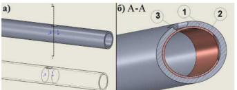
Рис. 1. Газопровод: a) горизонтальный участок газопровода со сквозным дефектом, б) разрез вида A-A, 1-газопровод, 2-ВГУ, 3- локальный сквозной дефект
