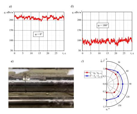
Рис. 2. Результаты эксперимента: а) временная теплограмма при конденсации на верхней и б) на нижней образующей горизонтальной трубы; в) фотография процесса;
