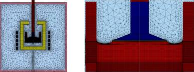
Рис. 2. Расчетная сетка в Basic CGSim, 23 тыс. ячеек
