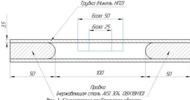
Рис. 1. Схематичное изображение образца
