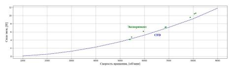
Рис. 3. Зависимость тяги от скорости вращения воздушного винта HQProp 9x5x3
