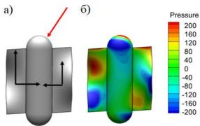
Рис. 3. а) Пример схемы сил, действующих со стороны плавников (черные цвет) и со стороны жидкости (красный цвет) на тело. б) Пример поля давления на аппарате в момент времени 40 с.
