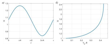
Рис. 3. а) Зависимость параметрического усиления от фазы при  $V_{DC}=2$  B,  $V_f=0.01$  B,  $V_p=0.3$  B;
