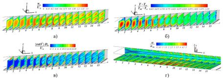
Рис. 3. Картины течения в канале квадратного сечения: а) продольная скорость, б) температура, в) завихренность, г) локальный параметр интенсификации теплоотдачи и донные линии тока
