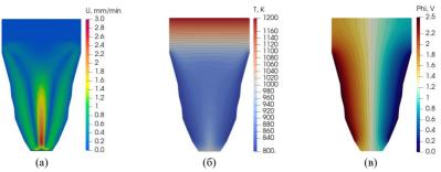
Рис. 4. Распределение величин (а) – температура, (б) – вязкость, (в) – модуль скорости
