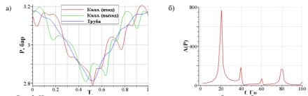
Рис. 2. Изменение среднемассового давления в коллекторах и трубе теплообменника за период взаимодействия с рабочей камерой (а), Фурье-спектр колебаний среднемассового давления газа в входном коллекторе (б)
