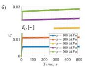
Рис. 3. Сравнение зависимостей осредненной интенсивности деформации  $\bar{\varepsilon_i}$  [-] от времени для: a) различных направлений (Ox и Oz) приложения нагрузки p=500 МПа, b0 различных уровней нагрузки от 100 МПа до 500 МПа при нагружении вдоль оси Oz
