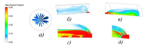
Рис. 3. Изоповерхность или распределение объемной доли газа для конфигурации: а) исходной форсунки; б) модифицированной форсунки с разными углами между осью отверстий и центральной осью; в) модифицированной форсунки с измененным размером и количеством отверстий; г) модифицированной форсунки с измененным размером и количеством отверстий, вблизи форсунки; д) модифицированной форсунки с использованием щитков, вблизи форсунки
