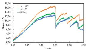
Рис. 2. Кривые напряжение-деформация для композита с различным углом α ориентации УНТ и «чистого» поликристалла
