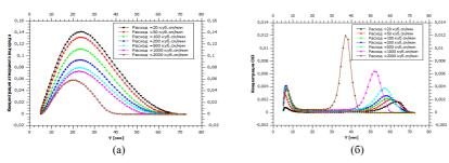
Рис. 3. Распределение концентрации радикалов вдоль оси симметрии реактора (подложка слева): (a)  $H_3$  (б)  $CH_3$
