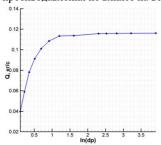
Рис. 3. Зависимость массового расхода от величины противодавления
