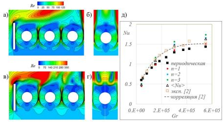
Рис. 2. Поля локального числа Рейнольдеа  $Re = Vd_0/v$ , полученные при а, в) N = 6 и б, г)  $N = \infty$ , для вариантов с разными перепадами температуры  $\Delta T$ : а, б)  $Gr = 4 \cdot 10^4$  и в, г)  $Gr = 5.5 \cdot 10^5$ ; д) график зависимости Nu от числа Gr для варианта  $S_1 = 58$  мм (G = 1.02)
