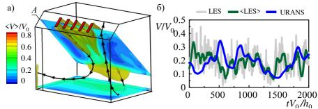
Рис. 2. а) Структура осредненного течения для варианта #1, б) эволюция скорости в точке мониторинга P, полученная в URANS и LES расчетах, <LES> — величины, осредненные по последовательным интервалам времени  $54 \cdot tV_0/H$
