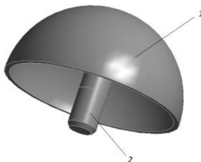
Рис. 1. Геометрическая модель полусферического резонатора: 1 – тонкостенная полусферическая оболочка, 2 – ножка
