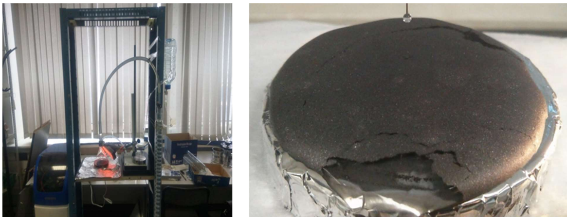
Рис. 1. Общая схема установки и вариант подложки для поверхностного испарения
