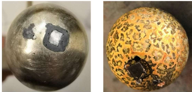
Рис.3. Поверхность шара до и после опытов
