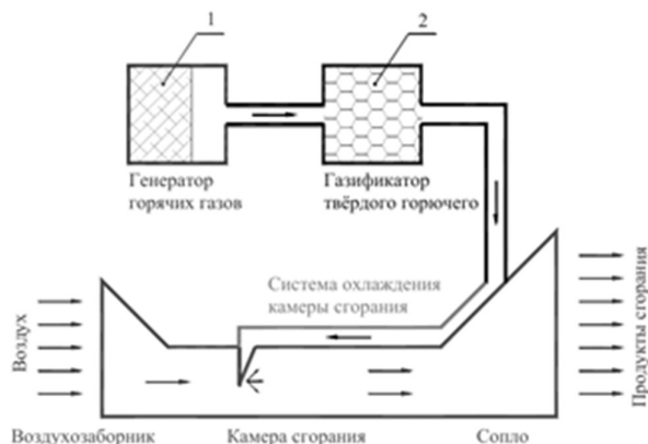
Рис. 1. Принципиальная схема высокоскоростного прямоточного воздушно-реактивного двигателя с низкотемпературным газогенератором [3]
