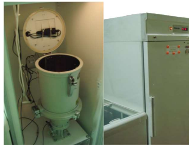
Рис. 2. Камера атмосферной сублимационной сушильной установки (справа) и бункерная сушилка (слева)
