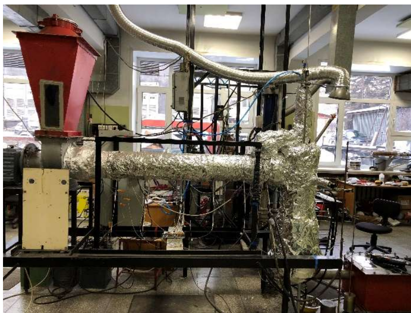
Рис. 1. Внешний вид лабораторного стенда многоступенчатой газификации древесных отходов
