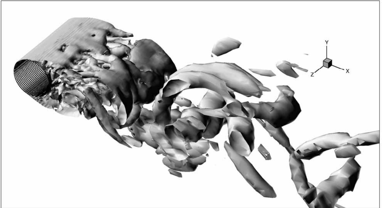
Рис. 5. Мгновенная картина докритического обтекания цилиндра при числе Рейнольдса 50,000 (изоповерхность величины “закрутки” \lambda=0.5 )
