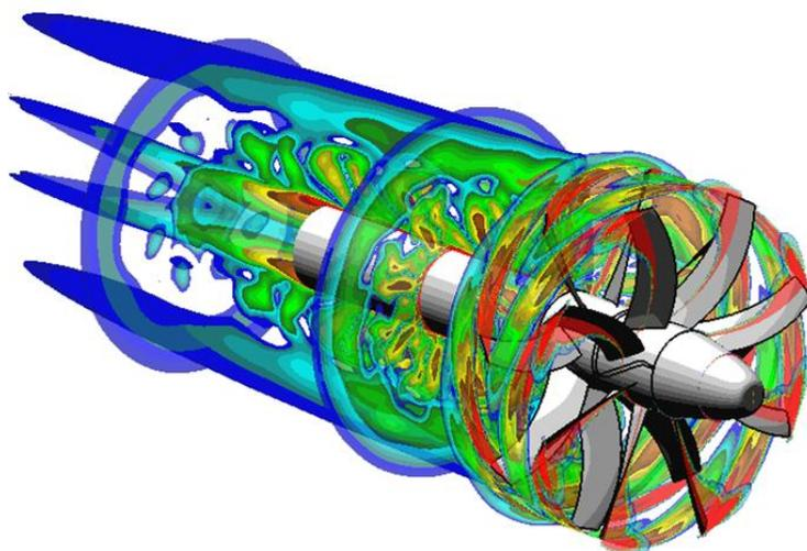
Структура вихрей при обтекании пропеллера турбовинтового самолета
